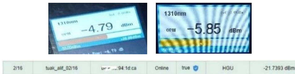
Gambar 26. Hasil Pengukuran OPM pada ODP-4 Jalur Timur
