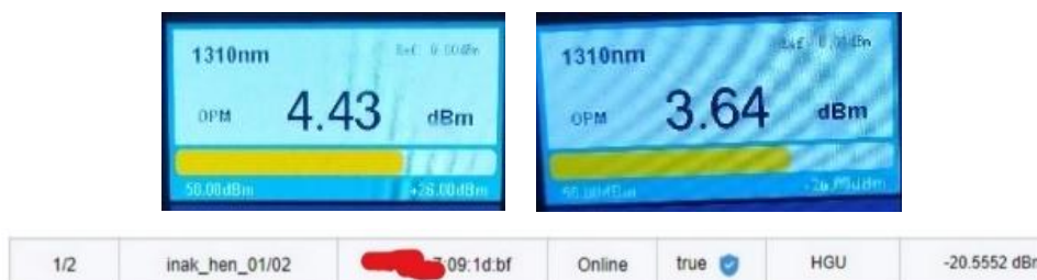
Gambar 9. Hasil Pengukuran OPM pada ODP-2 Jalur Barat
