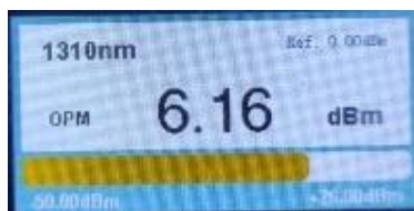
Gambar 19. Hasil Pengukuran OPM pada SFP
