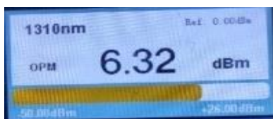
Gambar 6. Hasil Pengukuran OPM pada SFP
