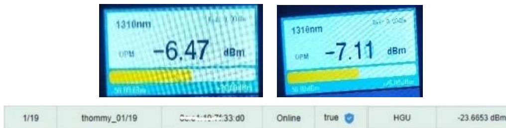
Gambar 15. Hasil Pengukuran OPM pada ODP-5 Jalur Barat
