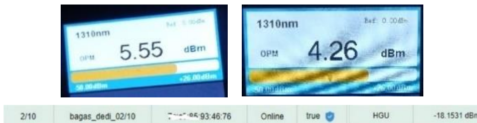
Gambar 20. Hasil Pengukuran OPM pada ODP-1 Jalur Timur
