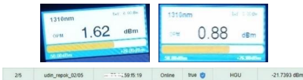
Gambar 22. Hasil Pengukuran OPM pada ODP-2 Jalur Timur
