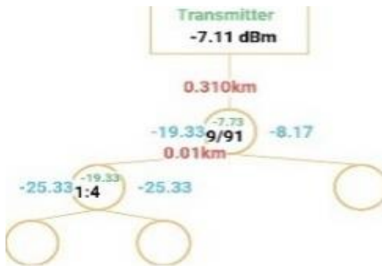
Gambar 18. Hasil Simulasi Pengukuran pada ODP-6 Jalur Barat
