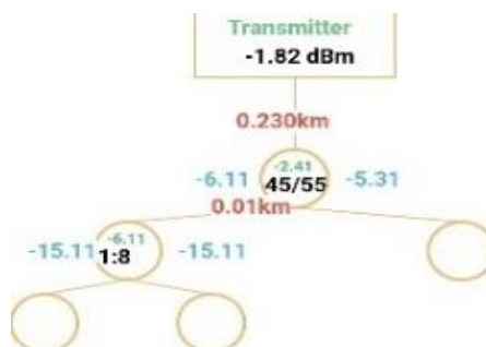
Gambar 27. Hasil Simulasi Pengukuran pada ODP-4 Jalur Timur
