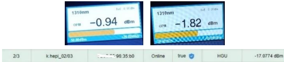
Gambar 24. Hasil Pengukuran OPM pada ODP-3 Jalur Timur
