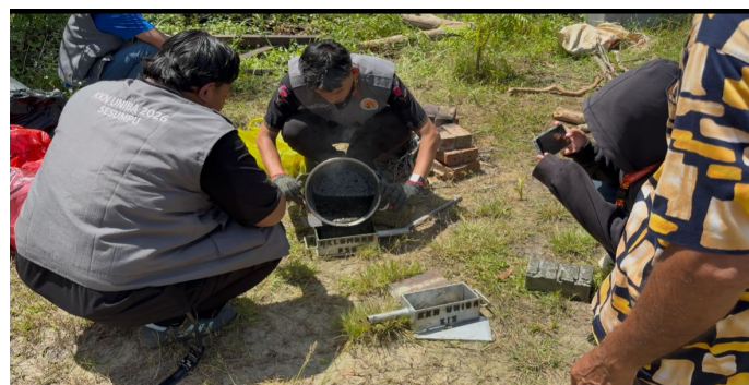
Gambar 7. Praktik Lapangan Pembuatan Paving Block
